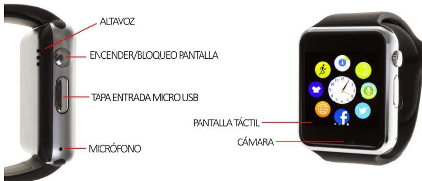
Pantalla táctil: Cada función del menú se muestra en la pantalla y se accede mediante presión táctil.
